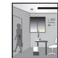
Con suficiente luz ambiental el sensor no enciende la luminaria incluso si se detecta la señal de movimiento.
